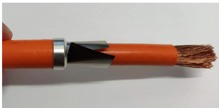
Figura 25 - La pellicola metallica viene sfilata dalla parte anteriore
