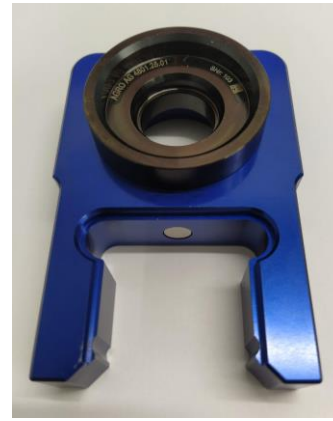
Figura 9 – Attrezzo di serraggio pronto con inserto di serraggio
