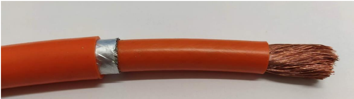
Figura 16 – Cavo tagliato a misura con la pellicola sopra la treccia di schermatura
