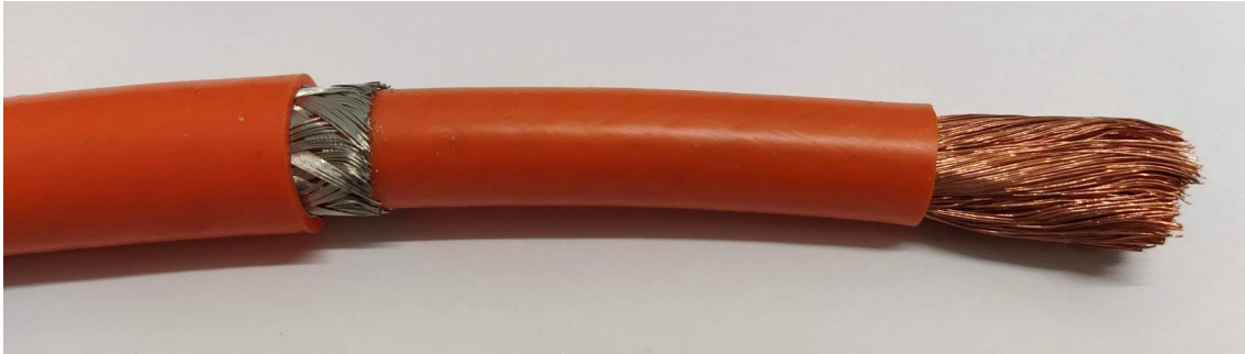
Figura 18 – Treccia si schermatura esposta
