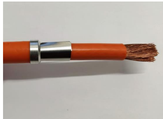
Figura 24 – Il manicotto di supporto in è battuta
