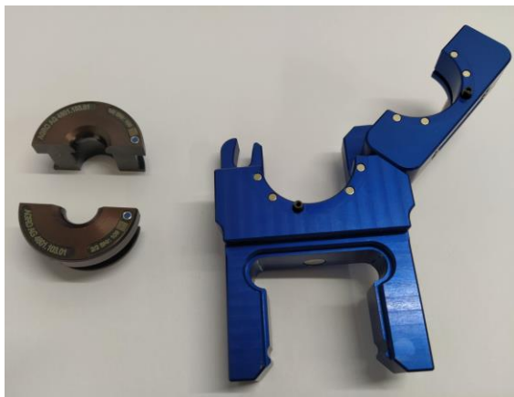
Figura 10 – Attrezzo di flangiatura e inserti di flangiatura
