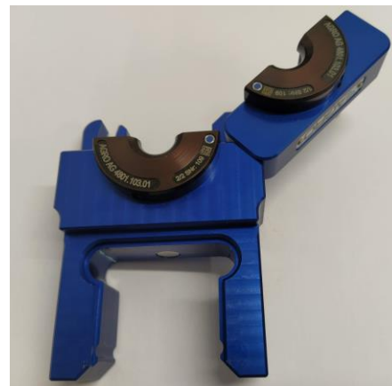
Figura 11 – Attrezzo di flangiatura con gli inserti di flangiatura montati
