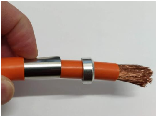
Figura 23 – La pellicola metallica è avvolta
