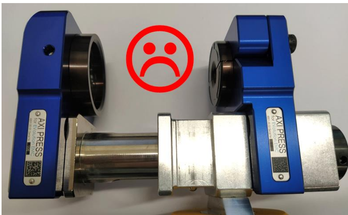
Figura 14 – Montaggio errato: attrezzi nelle posizioni di inserimento sbagliate
