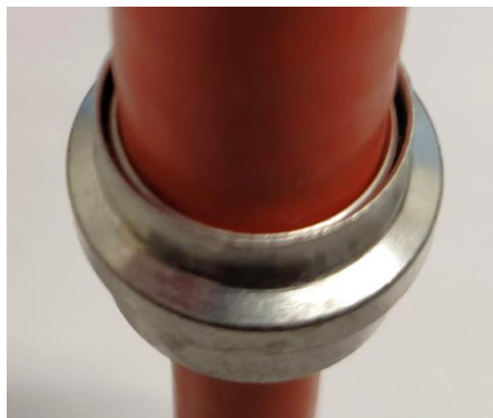
Figura 33 – Montaggio corretto del manicotto di contatto, non c'è eccesso di schermatura visibile.
